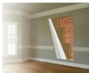
Obr. 4 – Skladba vnitřního zateplení systémem UdiIN
