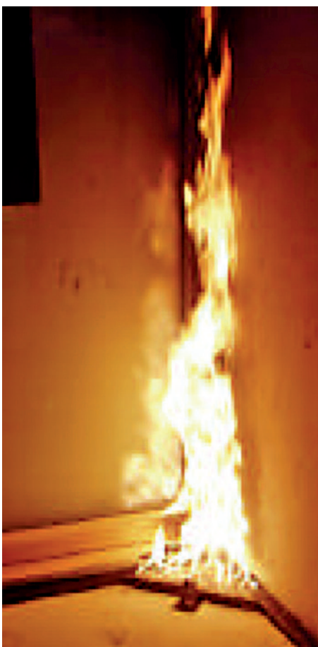
obr. 1 - Zkouška okna podle ČSN EN 13823
