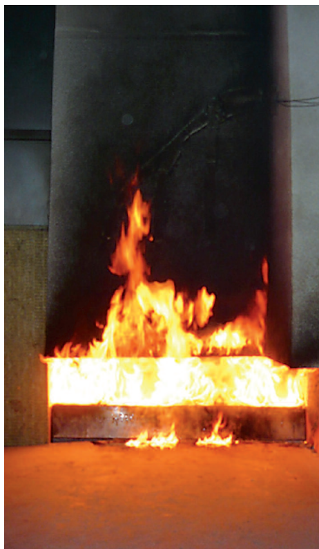
obr. 2 - Zkouška nadpraží podle ČSN ISO 13785-1
