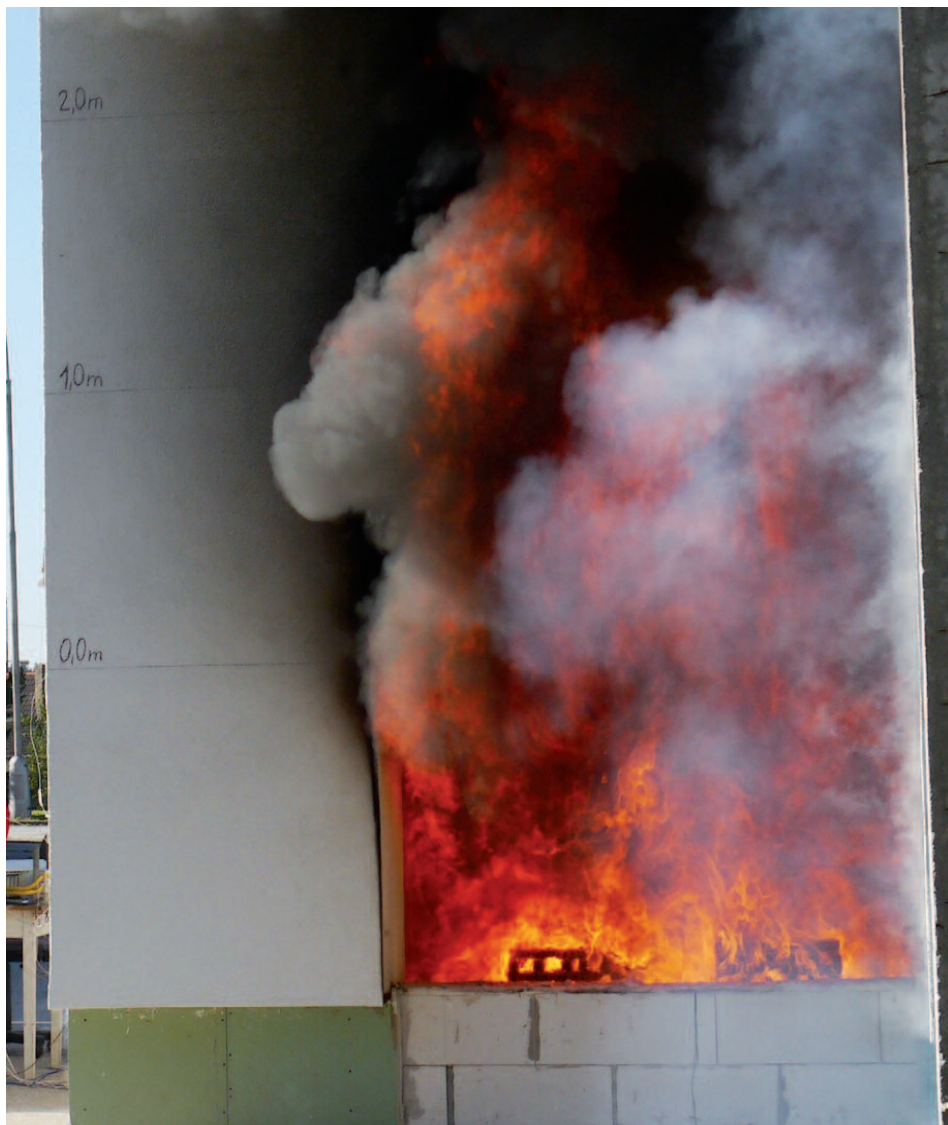
obr. 3 - Zkouška nadpraží podle ČSN ISO 13785-2
