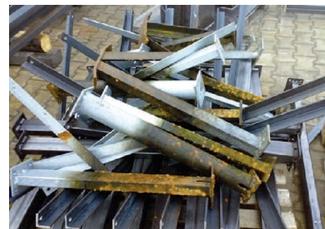
Obr.1. Pozinkované součásti po jednom roce expozice v přehradní nádrži. ( http://www.mmspektrum.com/clanek/zivotnost-a-zaruka-povlaku-zaroveho-zinku.html )
