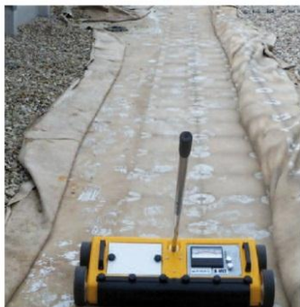
Obr. 4 – Provádění impedanční defektoskopie in-situ
