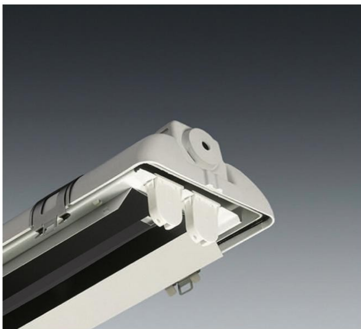
Obr. 4 – Zářivkové svítidlo s refraktorem, který upravuje směr vyzařování světla do potřebných míst. V případě použití náhražky je tato funkce značně znehodnocena.
