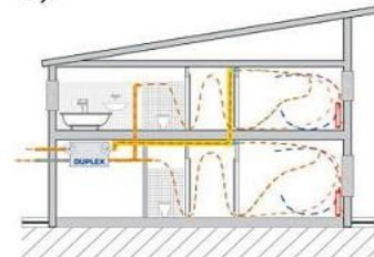
Schéma rovnotlakého větrání v RD
