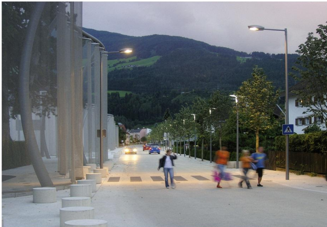
Obr. 7 – Dobře osvětlený přechod (včetně „ukázněných“ chodců). Oproti předešlému svítidlu je toto pro osvětlování přechodů předurčeno. Asymetrické vyzařování zajistí při správné pozici svítidla správné osvětlení chodce – Siteco SQ200.
