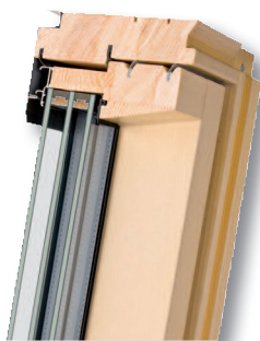
FTT U6 super energeticky úsporné zasklení U6 s vnitřním laminovaným bezpečnostním sklem tř. P2A
