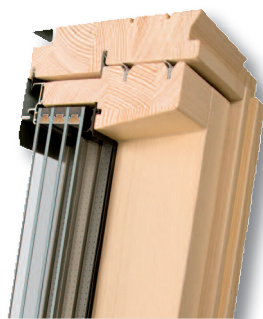
FTT U8 pasivní zasklení U8, – ve standardu vybaveno izolační sadou XDK, která obsahuje zateplovací sadu XDP a parotěsný límeč XDS – nejteplejší střešní okno na trhu. Dodává se a montuje výlučně s lemováním EHV-AT Thermo.
