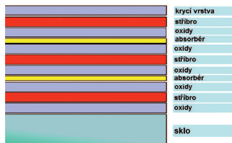
Obr. 7 – konstrukce povlaku s třemi vrstvami stříbra
