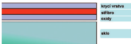
Obr. 5 – konstrukce povlaku s jednou vrstvou stříbra
